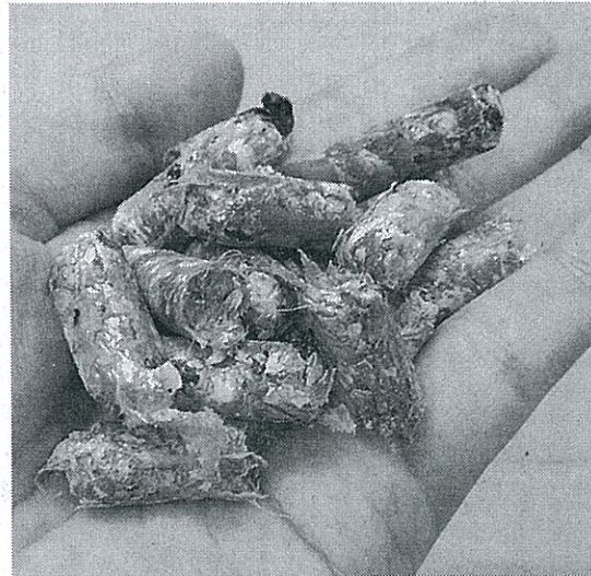
日本ウエストが業界で初めてJIS認証を取得した固形燃料のRPF
